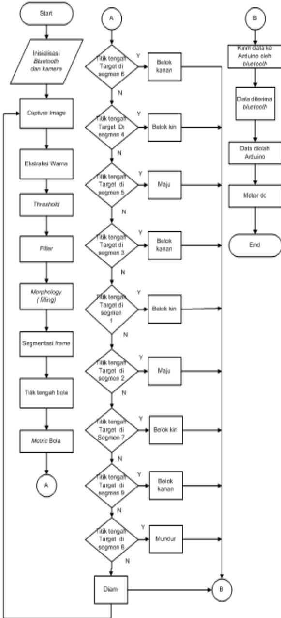
Gambar 24. Flowchart implementasi sistem pendeteksi target berdasarkan warna dan pola pada robot pengikut bola
